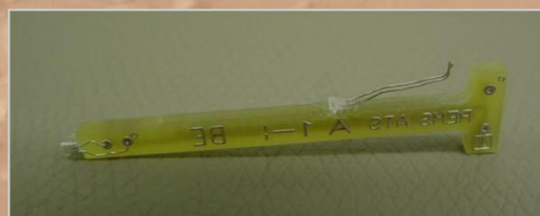
Figure 2.- Air Temperature Sensor.
